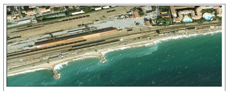
A quelque centaines de mètres à l'Ouest de la plage du Rocher on peut aussi observer que des épis à environ 150 mètres les uns des autres fixent le sable et créent des plages moins larges que celle du Rocher. Si la distance entre les épis augmente la largeur de la plage diminue. Dans cette zone aussi la plage disparait à l'Est quand il n'y a plus aucun épi.
