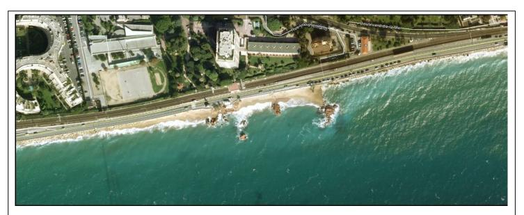
La plage du Rocher existe grâce aux trois épis constitués par les rochers et les murs qui les relient au mur de la route. La distance entre ces épis est d'environ 50 mètres. On peut observer qu'à l'Est de ces épis aucun sable n'est fixé. Dans cette zone, pas d'épi pas de plage.
